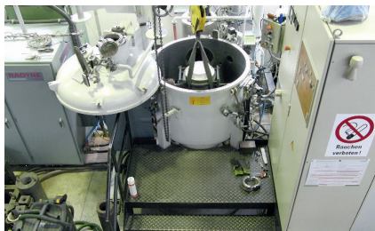
Abb.5: Vakuuminduktionsschmelzofen am IEST Quelle: VIGA, Eigenaufnahme (IEST)
