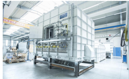
Abb. 4: Thermische Regenerierungsanlage Quelle: R. Scheuchl GmbH, 05/2015
