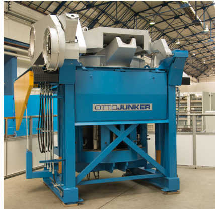
Abb. 5: Induktionsofen Quelle: OTTOJUNKER GmbH
